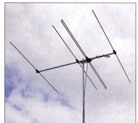
Bild 6: 4-Element-Yagi mit Faltdipol aus kommerzieller Fertigung von Konni [6]
