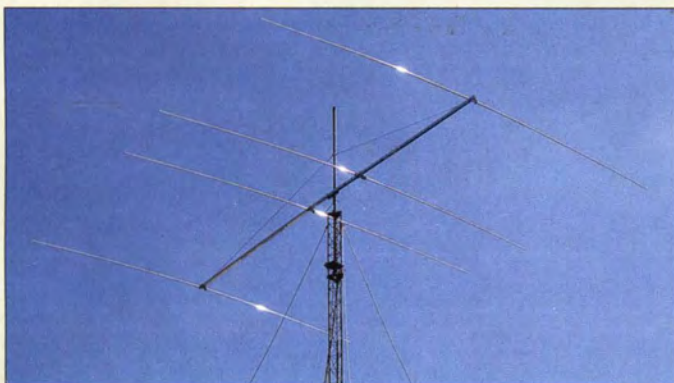
Der Beam MB4 20 mit vier Elementen bis 10,9 m Länge und 10 m Boom weist 11,9 dBd Gewinn bei 16,6 dB Vor-Rück-Verhältnis aus.
