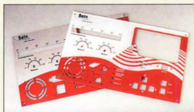
Per UV-Druck bedruckte Frontplatten aus Aluminium und Acryl
