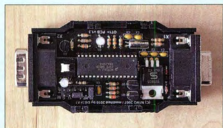
Bild 10: APRS-Tracker OT1+ im Gehäuse mit abgenommenem Deckel
