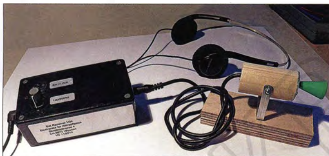
Bild 1: Breitband-Fledermausdetektor mit angeschlossenem Mikrofon auf einem Holzständer; als Trichter für das Mikrofon diente das Kunststoffhütchen aus einem Spiel.
