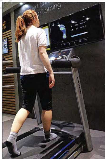
Sensor in der Socke: Damit der Schuh später nicht drückt, ermittelt dieses System drahtlos das individuelle Gehverhalten.
