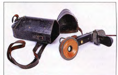
Bild 7: Der Eiserne Armeefernsprecher bestand lediglich aus dem Handapparat mit Hörmuschel, einem Mikrophon mit ausklappbarem Sprechtrichter und einer Summertaste.
