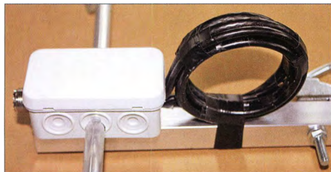
Bild 11: Blick auf die 30-Ω-Transformationsdrossel aus parallelgeschalteten 50-Ω- und 75-Ω-Koaxialkabeln RG58 und RG6
