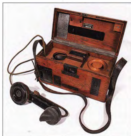
Bild 2: Ab 1916 war der Feldfernsprecher 16 Typ B das meistgenutzte deutsche Feldtelefon. Es hatte eine integrierte Stromversorgung und eine Masse von fast 9 kg.
