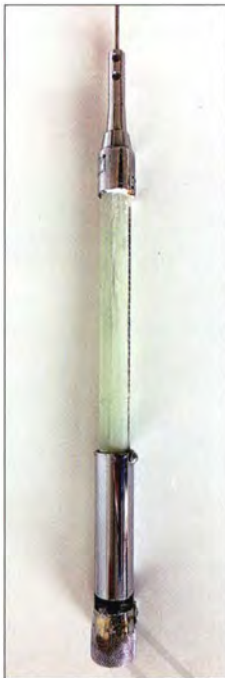
Bild 1: Ausgangspunkt für die Selbstanfertigung der Mobilantenne ist ein solcher oder ähnlicher kommerzieller Monobandstrahler, von dem hier im Bild zunächst der Kupferdraht der Original-Verlängerungsspule entfernt wurde.
