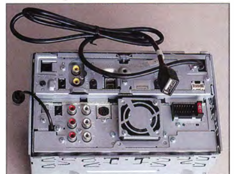
Rückseite des Kenwood DNX4250DAB: Ein Adapter vom Kenwood-eigenen Stecksystem auf die in hiesigen Automobilen üblichen Würfelstecker gehört zum Lieferumfang. Der USB-Port hängt an einem längeren Kabel, damit man diesen an einer geeigneten Stelle am Armaturenbrett befestigen kann.
