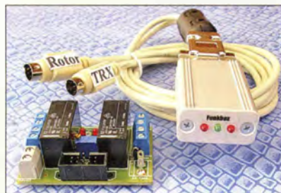
Rotorinterface TRXRotor, hier mit Relaisplatine für die Ansteuerung von Antennenrotoren ohne Interface-Anschluss
