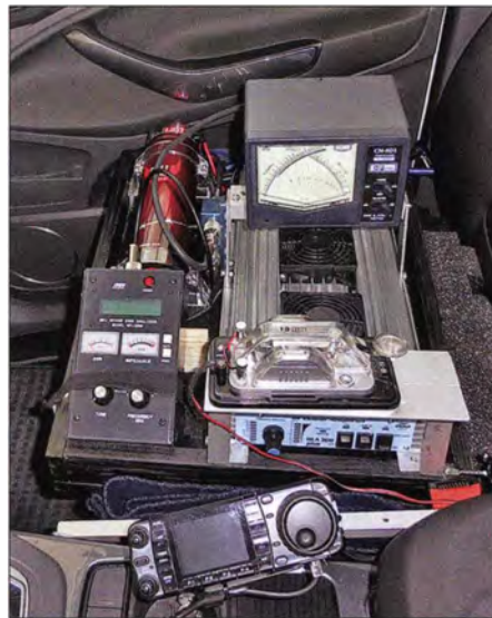
Bild 8: Das Montagebrett mit Endstufe, SWV-Messgerät, Antennenanalysator, Umschalter und 1-F-Pufferkondensator ist auf dem Beifahrersitz festgezurr.
